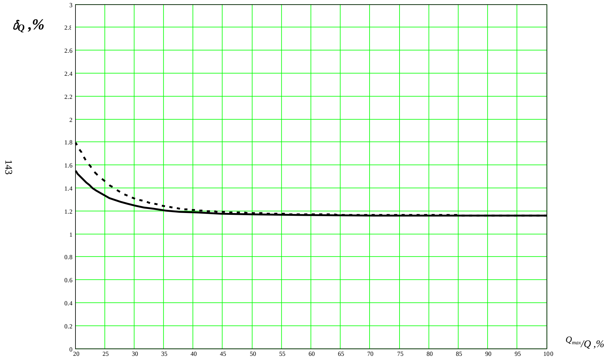
Рисунок Ж.1 - Изменение погрешности расходомера Метран-350-Р с датчиком давления 3051С в зависимости от расхода при измерении жидкости (измерение внутреннего диаметра по МИ 2667 (5.6.1.3 перечисление а)): диапазоны 0 и 1 - штриховая линия, диапазоны 2 и 3 - сплошная линия
