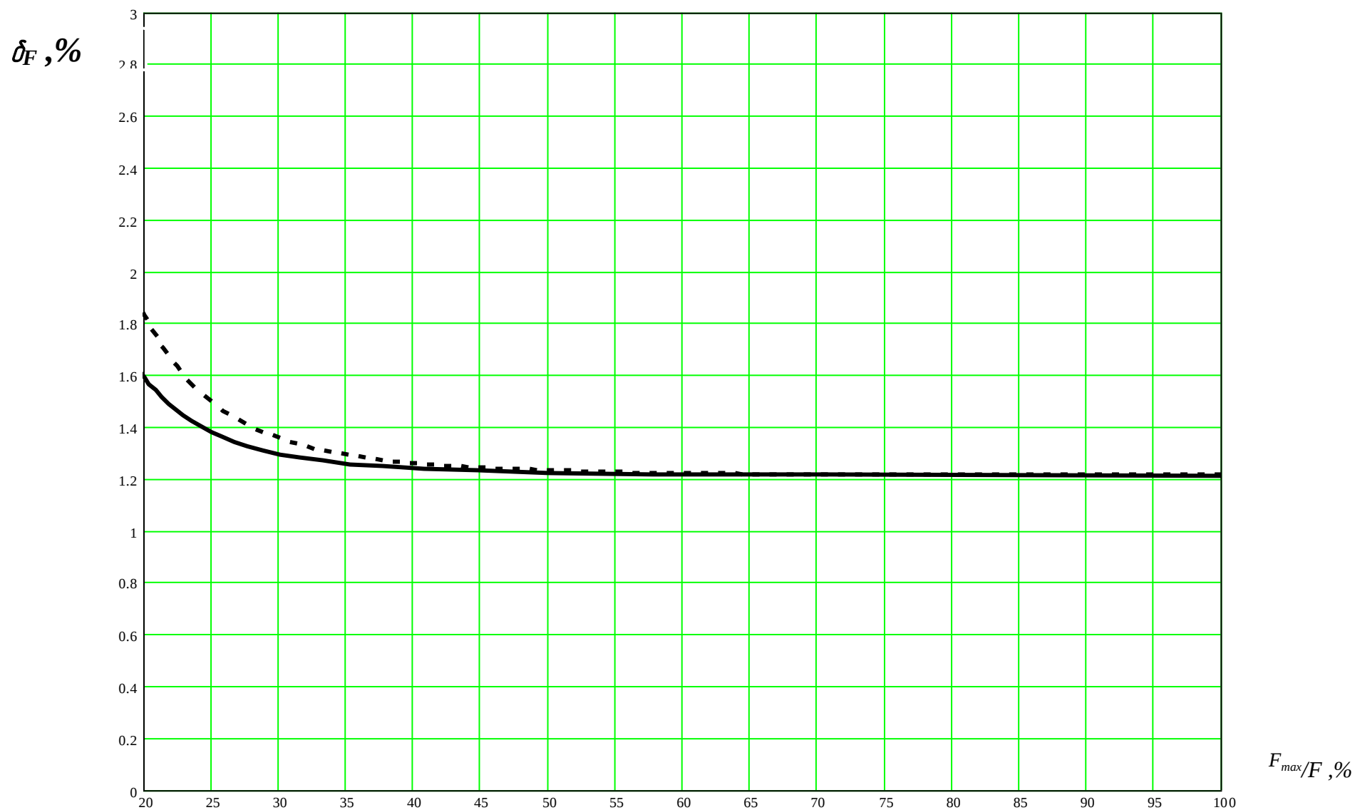
Рисунок Ж.7 - Изменение погрешности расходомера Метран-350-М в зависимости от расхода при измерении жидкости (измерение внутреннего диаметра по МИ 2667(5.6.1.3 перечисление а)): диапазон 1 - штриховая линия, диапазоны 2 и 3 - сплошная линия
