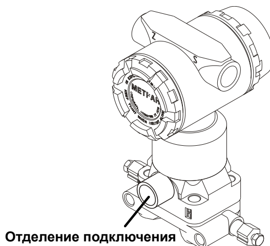
Рисунок 2.61 – Отделение подключения разъема крепления кабеля ТСП к датчику
