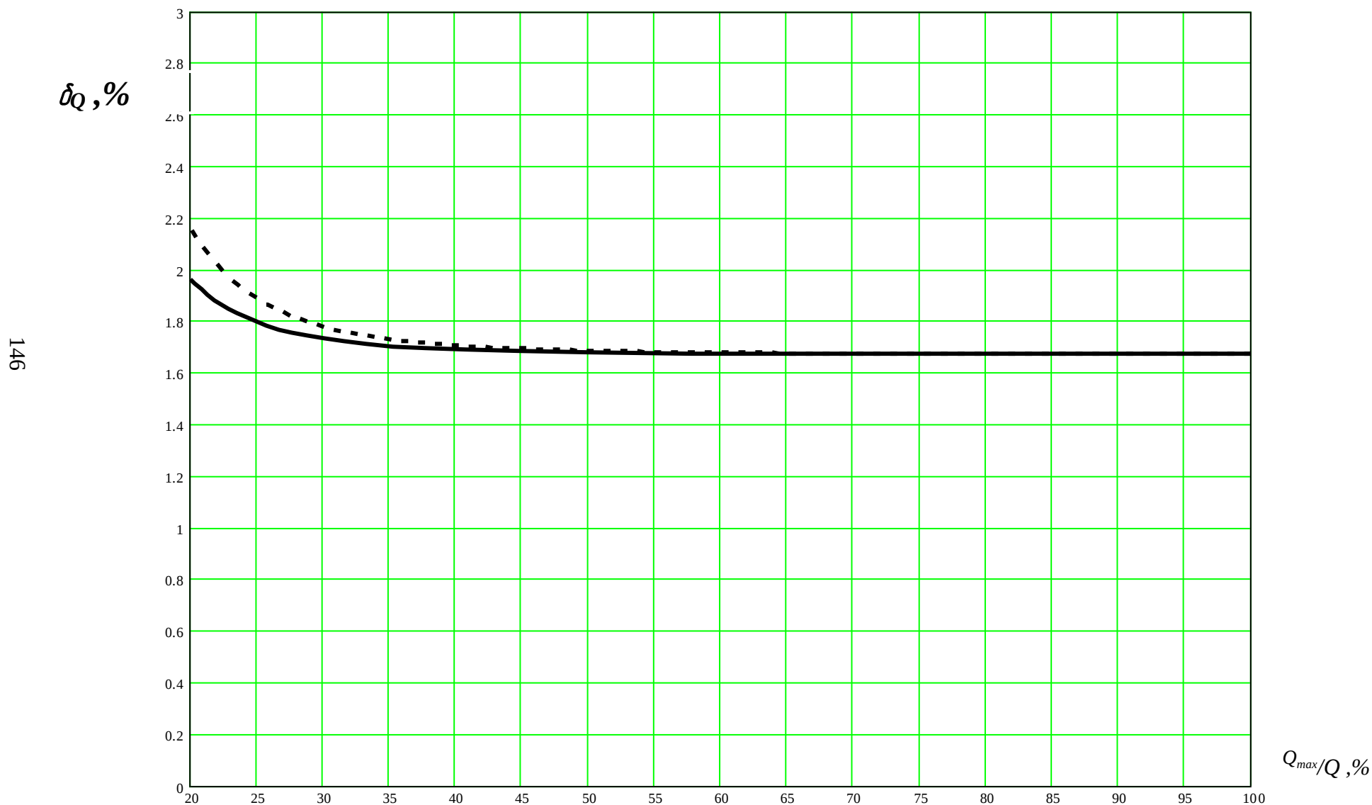
Рисунок Ж.4 - Изменение погрешности расходомера Метран-350-Р с датчиком давления 3051С в зависимости от расхода при измерении газа и пара (измерение внутреннего диаметра по МИ 2667 (5.6.1.3 перечисление а)): диапазоны 0 и 1 - штриховая линия, диапазоны 2 и 3 - сплошная линия
