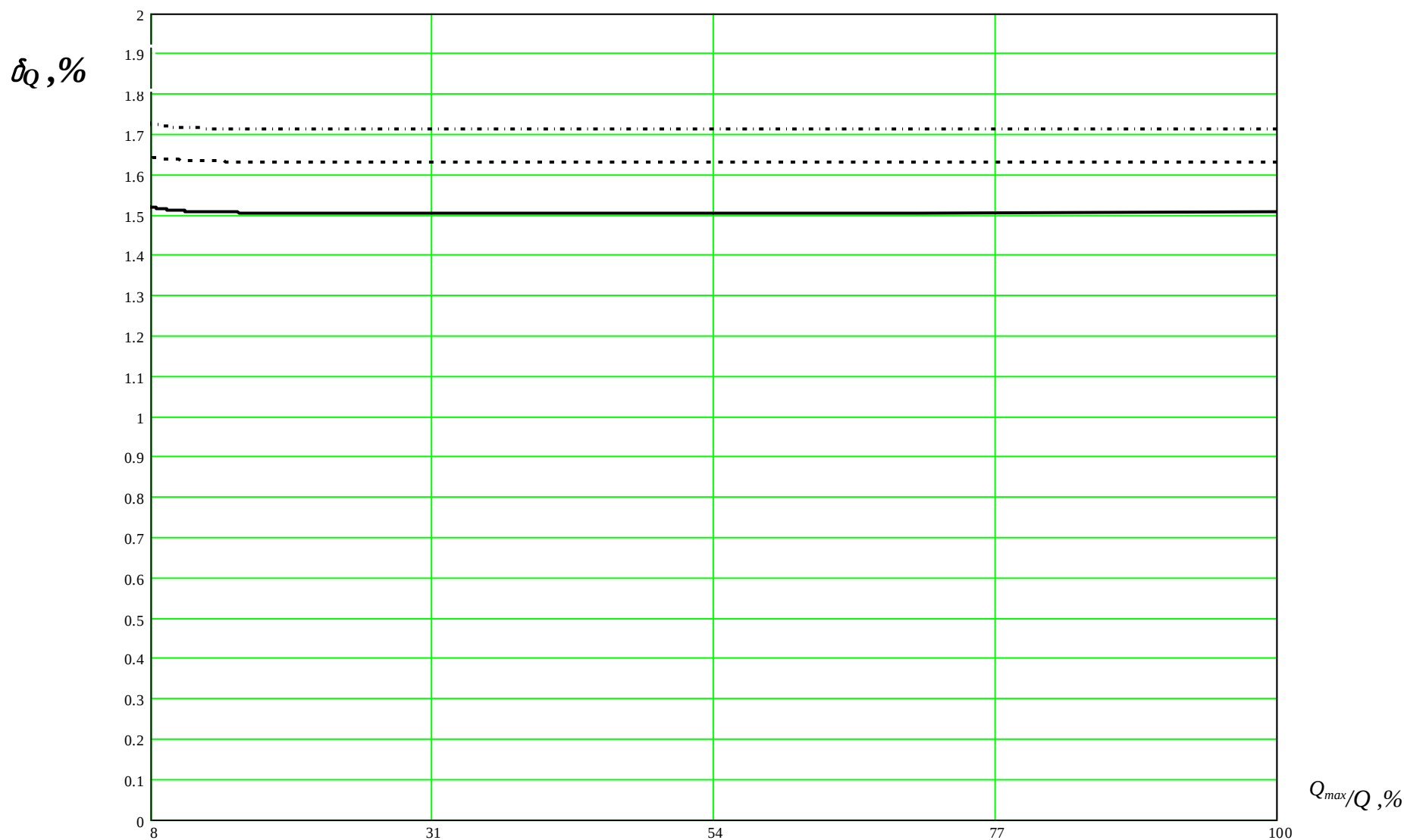
Рисунок Ж.26 - Изменение погрешности расходомера Метран-350-SFA (Ultra For Flow) в зависимости от расхода при измерении газа и пара для диапазонов 2А и 3А: сплошная линия - измерение внутреннего диаметра по МИ 2667 (5.6.1.3 перечисление а); штриховая линия - измерение внутреннего диаметра по МИ 2667 (5.6.1.3 перечисление б); штрих-пунктирная - измерение внутреннего диаметра по ГОСТ 8.586.2 (6.4.2), ГОСТ 8.586.3 (6.4.2), ГОСТ 8.586.4 (5.2.2)
