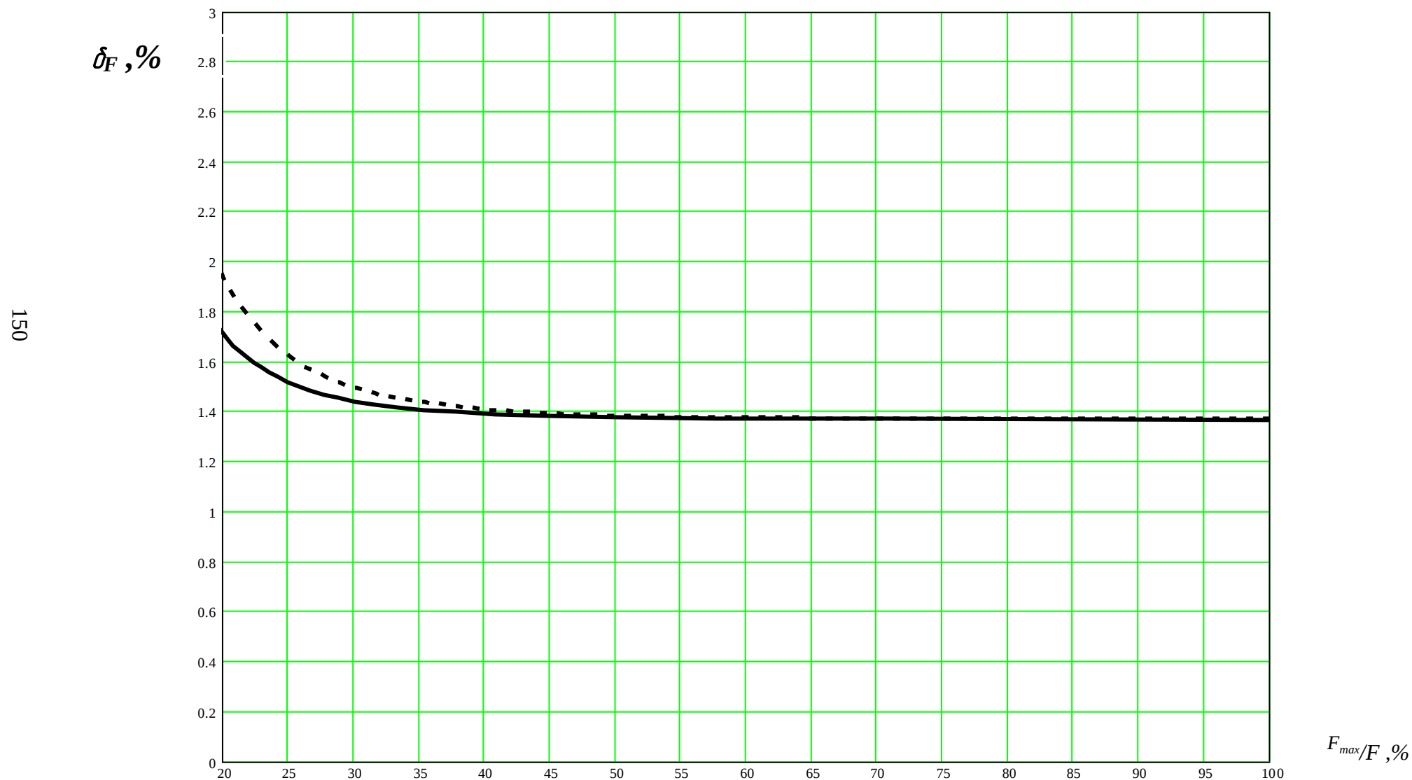
Рисунок Ж.8 - Изменение погрешности расходомера Метран-350-М в зависимости от расхода при измерении жидкости (измерение внутреннего диаметра по МИ 2667 (5.6.1.3 перечисление б)): диапазон 1 - штриховая линия, диапазоны 2 и 3 - сплошная линия
