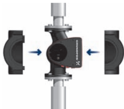
Рис. 24 Установка теплоизоляционного кожуха на насос MAGNA1
